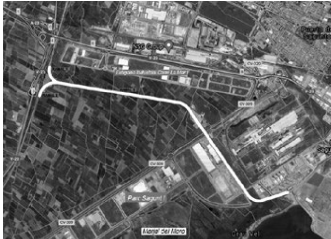
Trazado del nuevo acceso al puerto marítimo.
